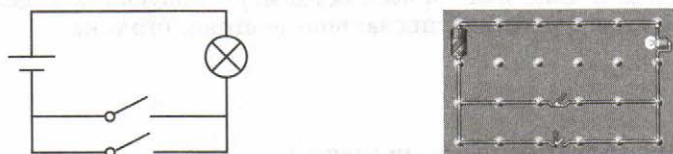
Рис. 3.4. Электрическая схема модели логического элемента «ИЛИ» и ее реализация в компьютерном конструкторе «Начала электроники»
