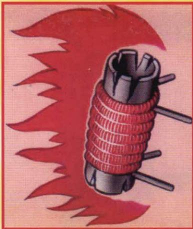
Категорически запрещается соединение проводов в виде скрутки, потому что надежность соединения и плотность контактов проводников ослабевает, со временем уменьшается площадь их контакта, возможна искрение, образование электрической дуги, короткое замыкание. Тем более недопустимо соединение медных и алюминиевых проводов. Для этого используются стандартные клеммные колодки, также разрешены болтовые, винтовые соединения проводов, сварка, прессовка.
